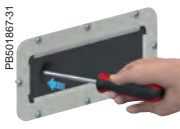
Проделайте отверстие с помощью отвёртки
